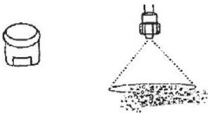
1. Boquilla de abanico: Esta boquilla da una vaporización uniforme sobre el objetivo. Diseñado para el rociado de pesticidas. Siga el viento y mueva en un lado paralelo durante el rociado.
